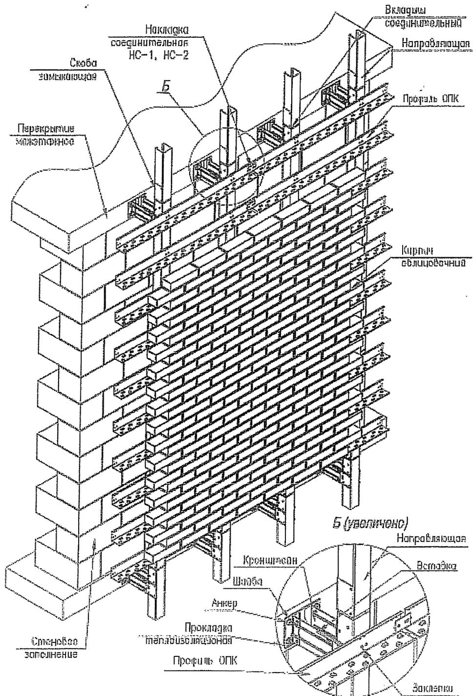
Рис.1 Фрагмент навесной фасадной системы «ОЛМА» для облицовки фасадным кирпичом.
